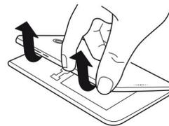
4. Si une batterie est en place, insérez votre ongle dans la fente juste sous la batterie sur la droite et retirez la batterie en la soulevant.
