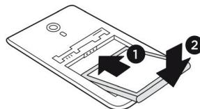
6. Glissez la batterie en place. Appuyez délicatement sur la partie basse de la batterie pour qu'elle se loge en position.
